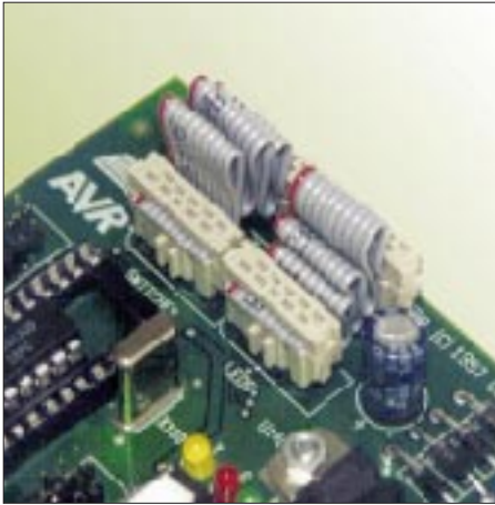
Bild 2: Flachbandleitungen verbinden die I/O-Leitungen.
